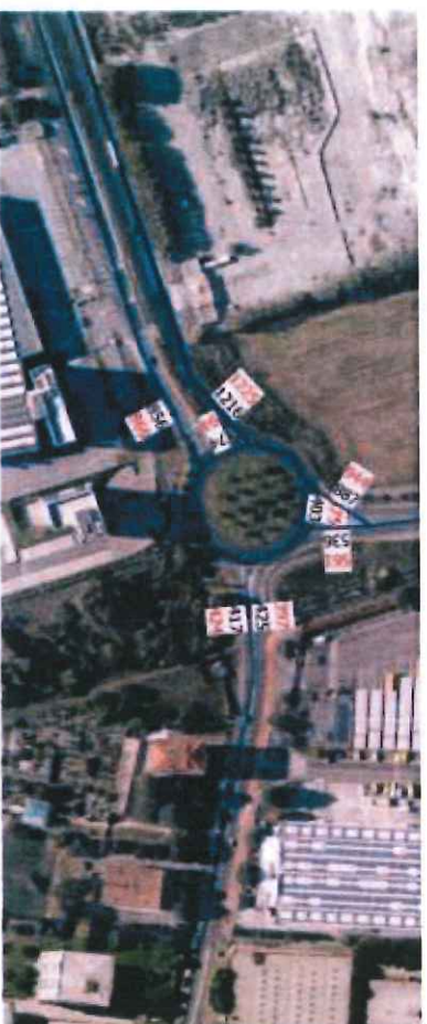
Figura 34 – Rotatoria 2: raffronto tra flussi rilevati (in rosso) e flussi simulati (in blu) – ora di punta della sera
