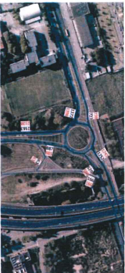
Figura 33 – Rotatoria 1: raffronto tra flussi rilevati (in rosso) e flussi simulati (in blu) – ora di punta della sera
