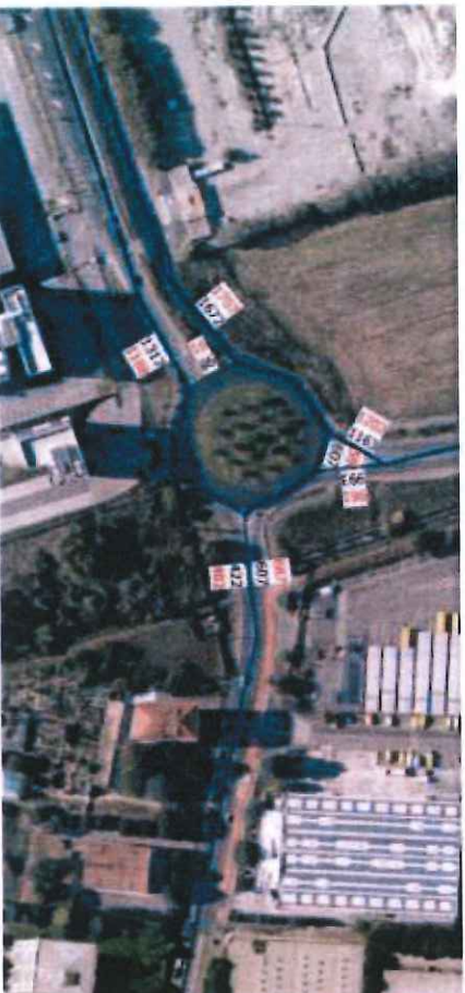
Figura 30 – Rotatoria 2: raffronto fra flussi rilevati (in rosso) e flussi simulati (in blu) – ora di punta del mattino
