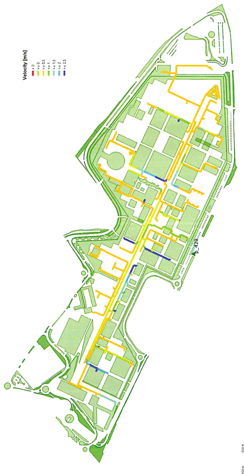
EL 2 - Planimetria della rete e distribuzione delle velocità in condotta per la soluzione progettuale adottata ( P = 700 \text{ kPa} )
