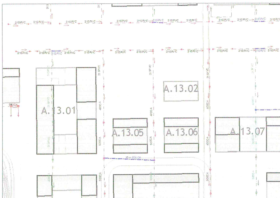
Figura 26 Stralcio tavola di progetto, in rosso i condotti esistenti mantenuti, in verde quelli demoliti e in blu i nuovi collegamenti/potenziamenti
