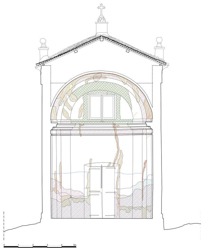
Sezione C-C' Analisi del degrado
