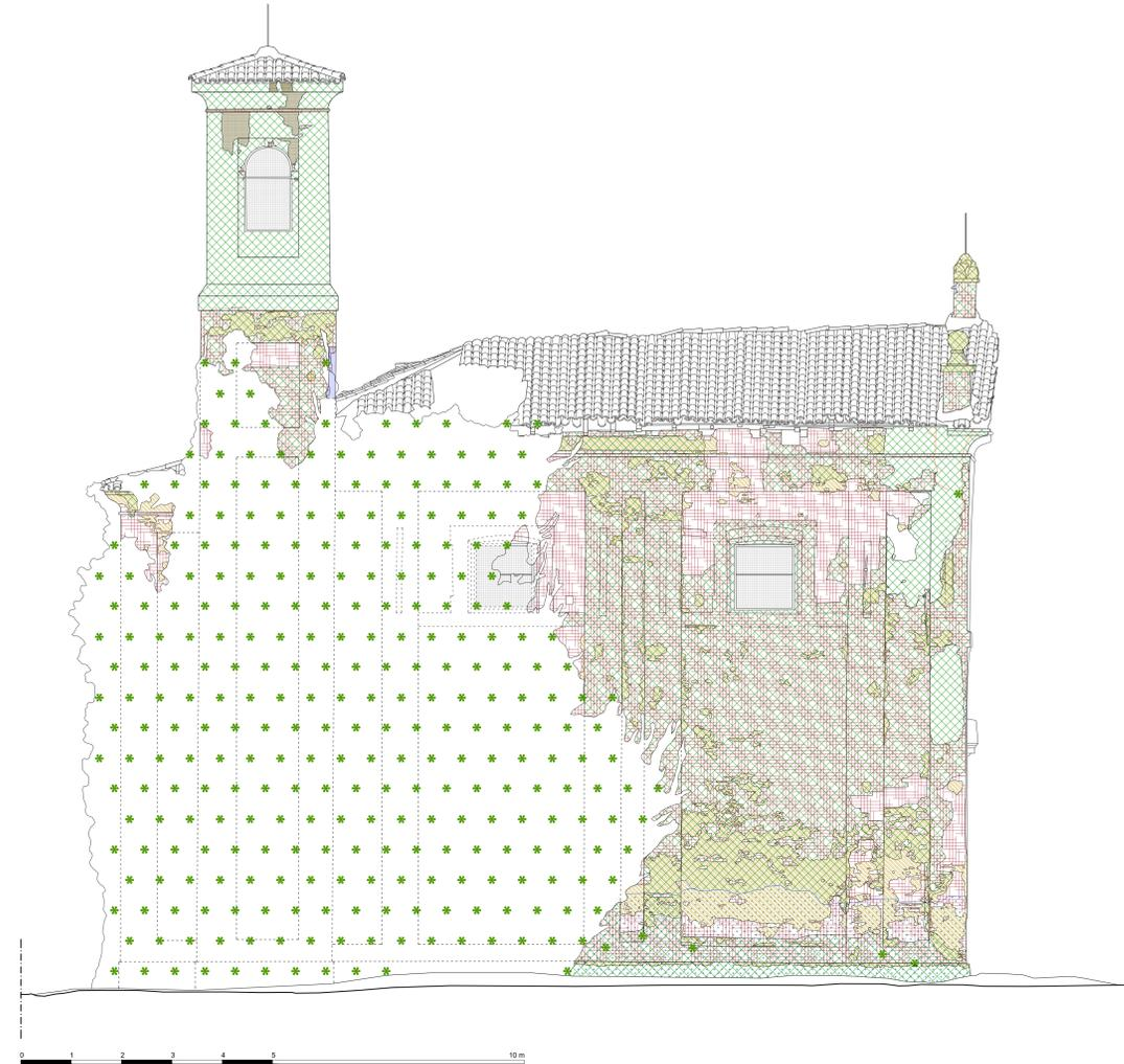
scala 1:50 Prospetto 2-2' Analisi del degrado
