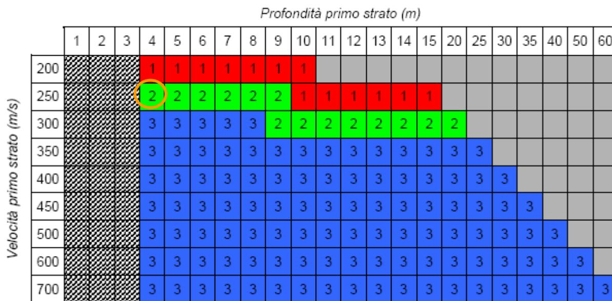
Abaco che permette di individuare, in base al colore, la curva di riferimento per l'individuazione di  $F_a$ , grazie all'intersezione della profondità raggiunta dal primo strato e la sua velocità
