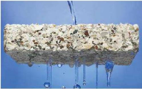
Calcestruzzo drenante costituito da una miscela in conglomerato cementizio contenente inerti, acqua, cemento e additivi, appositamente studiata per applicazioni stradali e compatibile con la sovrapposizione di strati in conglomerato bituminoso. Saranno impiegati aggregati conformi alla UNI EN 12620:2003, e aventi i seguenti requisiti:
