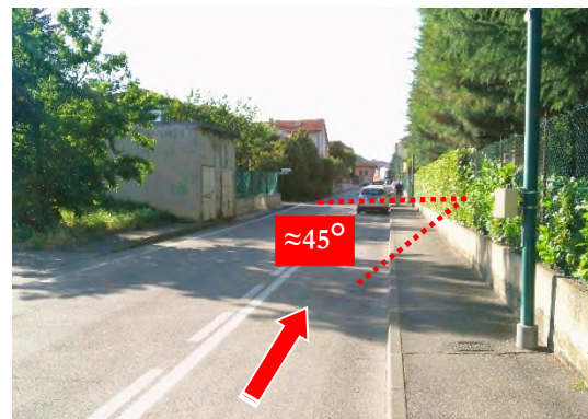
Figura 21 – Angolo di installazione dei radar rispetto alla direzione di marcia
